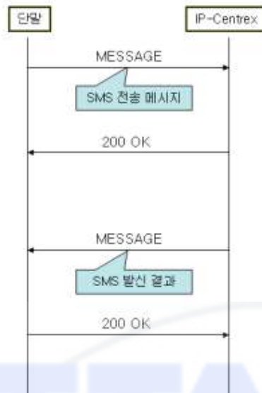
(그림 6-1) SMS 발신 Call Flow
